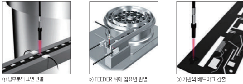
① 팁부분의 표면 판별 ② FEEDER 위에 칩표면 판별 ③ 기판의 배드마크 검출
